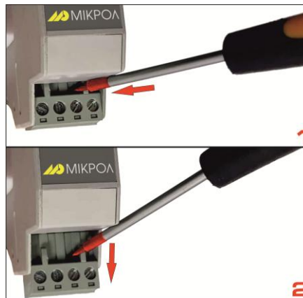
Рисунок 3.3 – Схема вилучення роз'єм-клеми за допомогою плоскої викрутки
